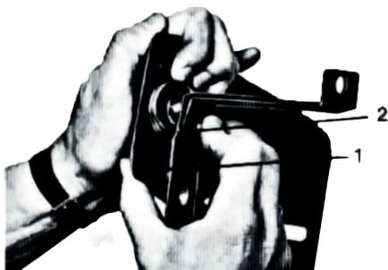
3. Placez le boulon (A) dans le safran avec le disque à l'extrémité, pour que le boulon dépasse de 5-6 mm à l'intérieur du safran. La moitié de la bride correspondante avec le côté oblique dirigé vers l'extrémité du ressort (voir flèche 1), est amenée vers le ressort, pour que l'extrémité du ressort vienne à l'avant de la bride (voir flèche 2).
