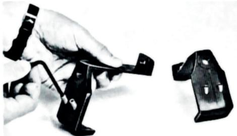
1. Entrez les vis (C) dans les brides mais ne les vissez pas à travers la plaque. Veillez à ce que les vis entrent droites dans les passages de vis obliques. Le pas de vis doit être graissé.
