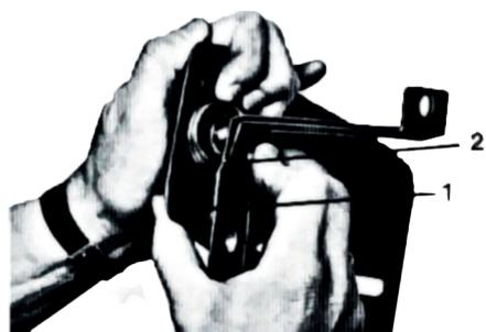
3. Bolzen (A) mit Scheibe am Ende so in das Ruderblatt einsetzen, dass der Bolzen auf der Innenseite des Ruderblatts ca. 5-6mm übersteht. Die zugehörige Halterungshälfte mit der abgeschrägten Kante dem Federbein zugewandt (siehe Pfeil 1) gegen die Feder führen, so dass das Federbein auf die Vorderseite der Halterung kommt (siehe Pfeil 2).
